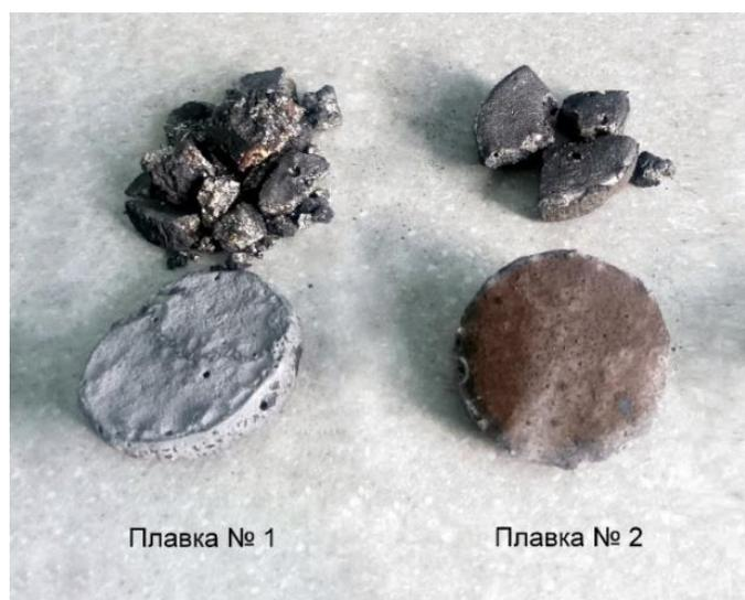
Рисунок 39 – Опытные образцы сплавов феррохрома и шлака
