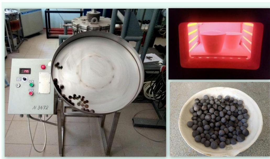
Рисунок 15 – Лабораторный тарельчатый гранулятор (а) и муфельная печь (b), используемая для наработки обожженных окатышей (с)
