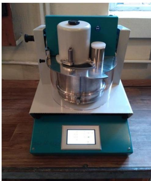
Рисунок 29 – Смеситель-гранулятор фирмы Eirich
