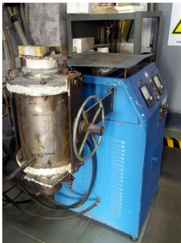
1 – корпус печи, 2 – графитовый нагреватель, 3 – огнеупорная засыпка (глинозем  $Al_2O_3$ ), 4 – алундовая труба, 5 – графитовый токоподвод, 6 – тигель с шихтой и окатышами, 7, 8 – клеммы токоподвода, 9 – огнеупорная крышка, 10 – термопара, 11 – термоконтроллер
