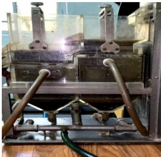
Рисунок 25 – Лабораторная отсадочная машина
