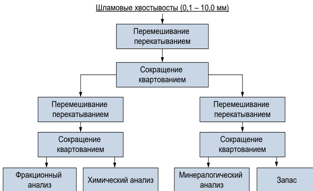
Рисунок 1 – Схема разделки шламовых хвостов
